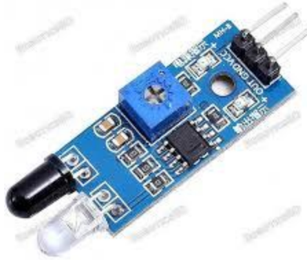
figure:3.1.4: ir sensor module
